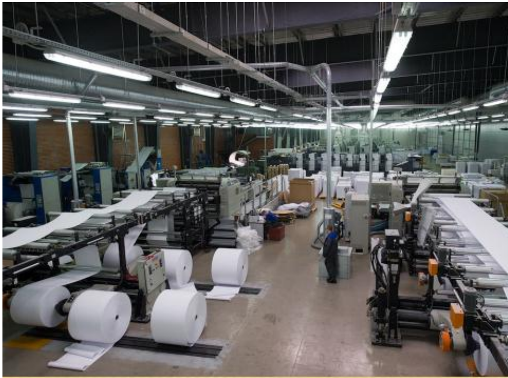
Фото 3 Автоматизированный участок подготовки бумаги
